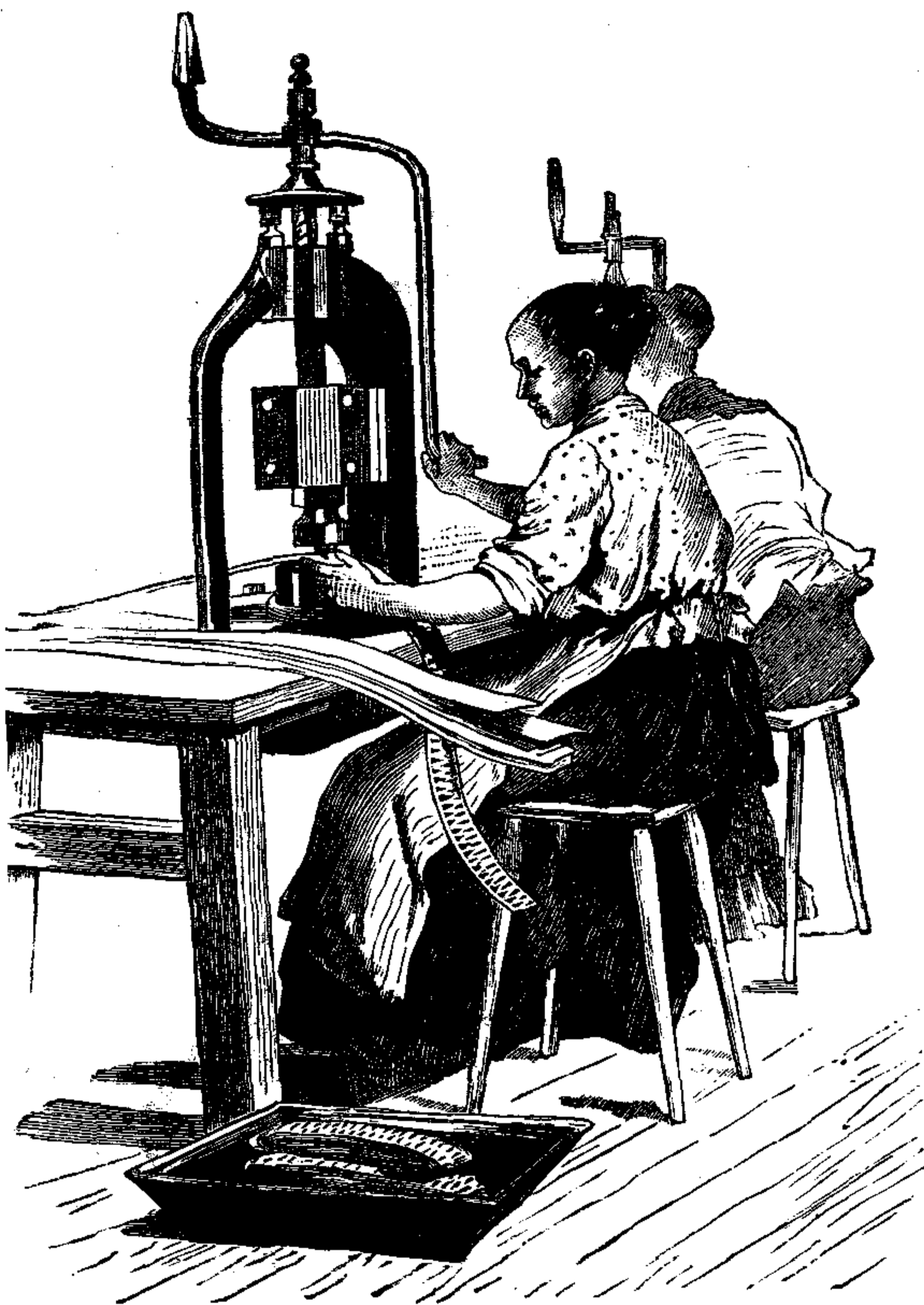
410. Выбивка заготовок на перья.
